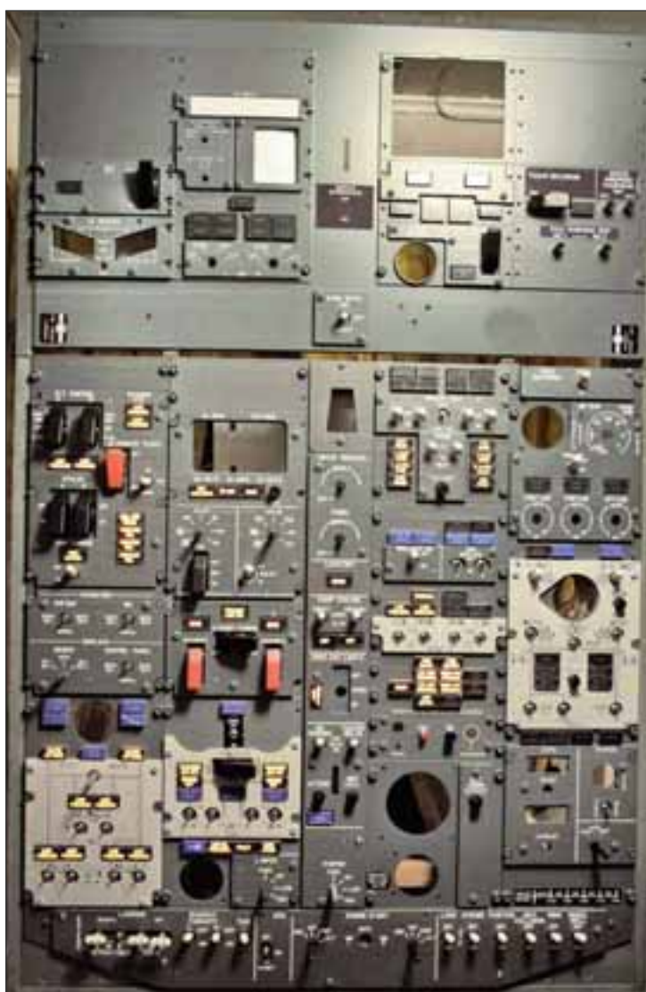
150 TIMER SENERE... ser det slik ut. Nå er det montert 101 varsellys, cirka 80 brytere, seks analoge instrumenter pluss behørig merking på engelsk, selvfølgelig.
