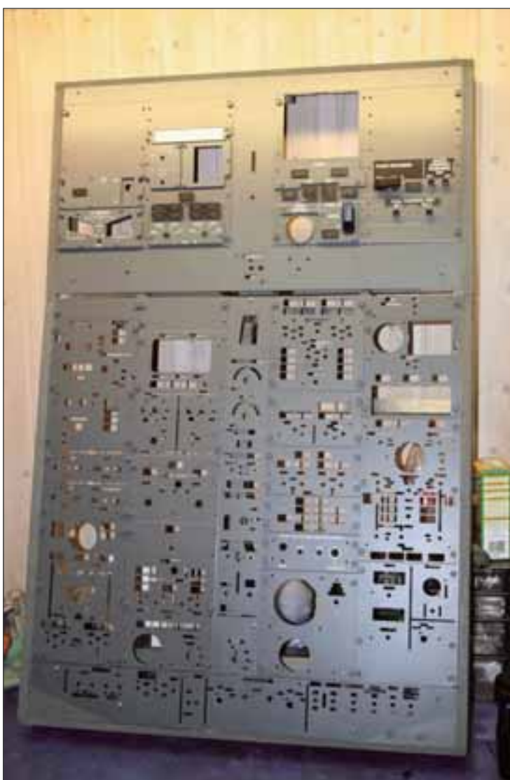
STARTEN: Her er starten på prosjektet Dette skulle bli instrumentpanelet i cockpit-taket.
